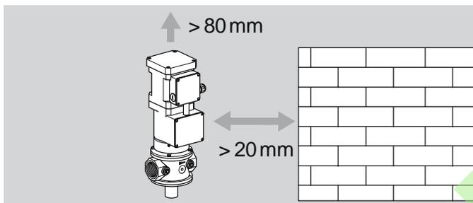
Das Gas-Motorventil VK darf kein Mauerwerk berühren. Mindestabstand 20 mm zur Seite.
