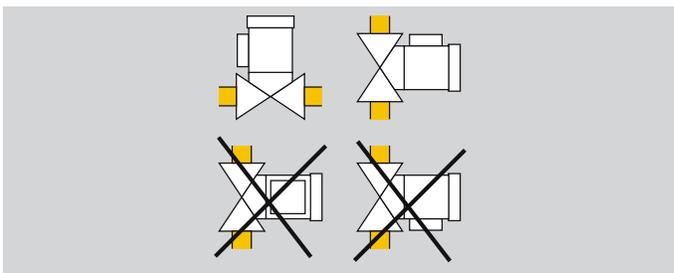
Einbaulage: Antrieb senkrecht stehend bis waagrecht liegend, nicht über Kopf. Der Anschlusskasten muss nach oben zeigen.
